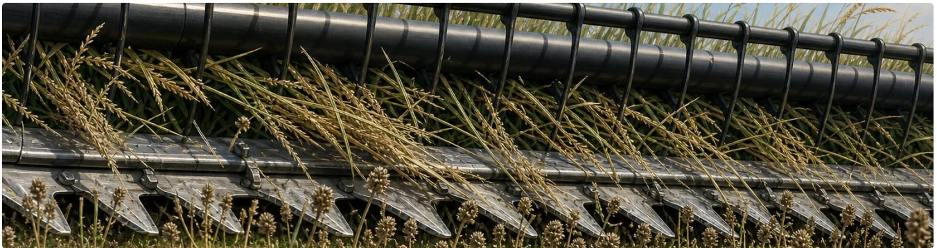
Una cosechadora corta cabezas de semillas de pasto alto y deja debajo de la cuchilla las cabezas más bajas de semillas de malezas.
