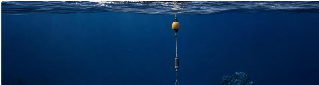
Un barco de investigación baja un sismómetro impermeable al océano para monitorear las vibraciones de los terremotos en el fondo marino.
